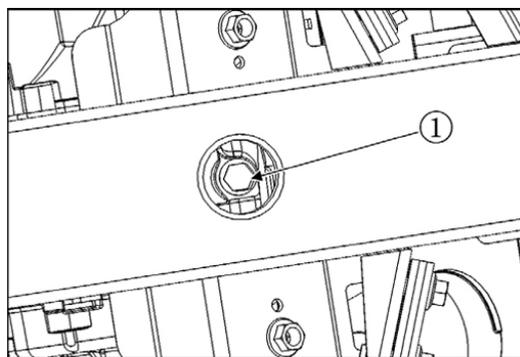
①发动机放油螺栓（发动机底部）
