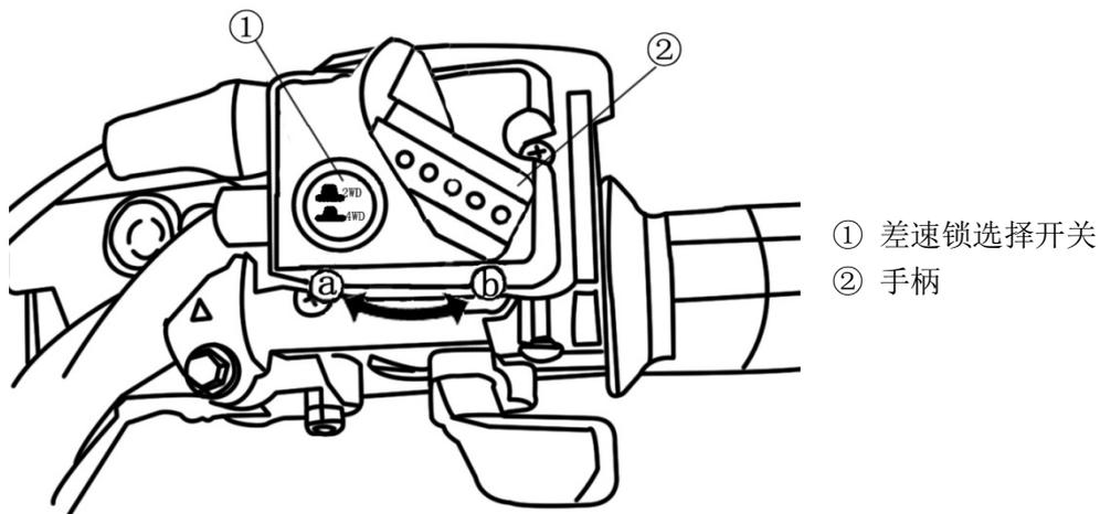
锁住差速齿轮到 4WD，确保四轮驱动设置到“4WD”停下 ATV，移动手柄到②位置，然后设置开关到“LOCK”。当差速齿轮被锁住，差速齿轮锁指示器（“DIFF. LOCK”）灯将随着指示器“
